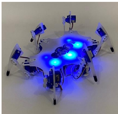
Slika 7. STEMI Hexapod robot
